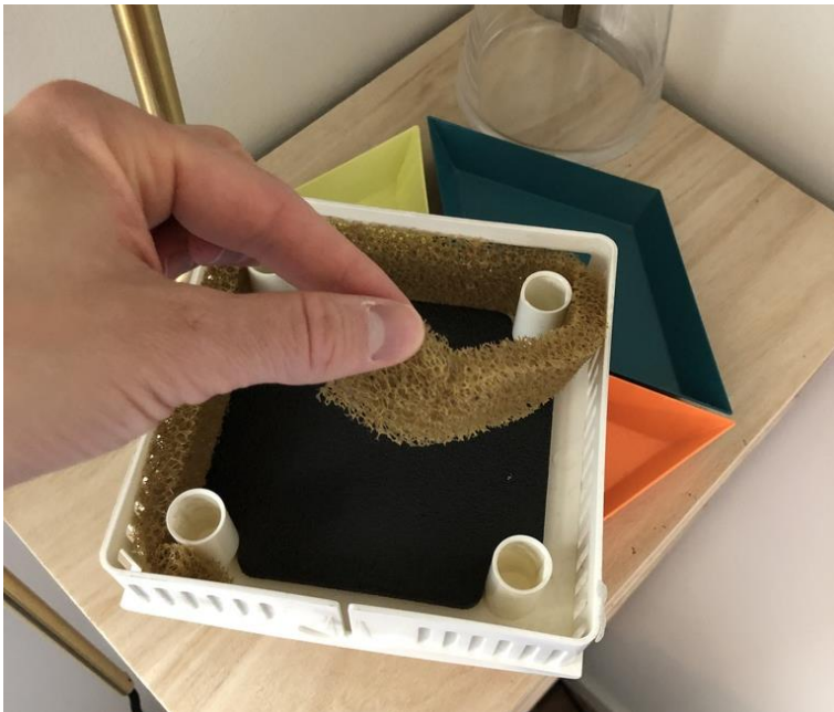
Figur 4: Vær obs på hvordan filteret er satt inn når det tas ut. Det skal dekke luftehullene i dekselet.
